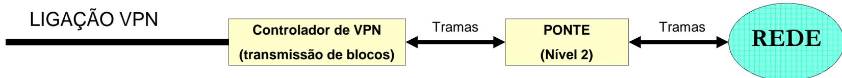
Todos os dados que circulam em tramas numa das redes propagam-se até à rede remota, independentemente do protocolos em causa. As duas redes interligadas são obrigatoriamente do mesmo tipo, caso contrário os formatos de trama seriam diferentes. Sob o ponto de vista das camadas superiores, as duas redes passam a ser apenas uma única.
