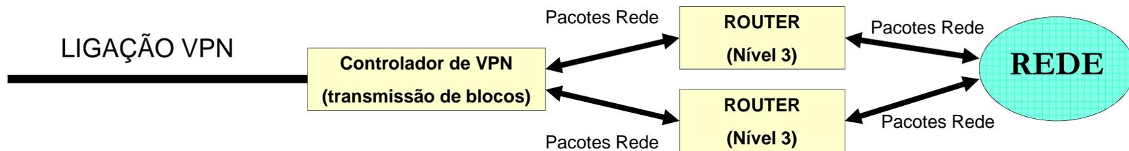
Como as redes não estão ligadas no nível 2 o tráfego em *broadcast* não passa através da VPN. As redes interligadas mantêm-se separadas no nível 2 e irão por isso constituir redes distintas sob o ponto de vista dos protocolos de nível 3.
