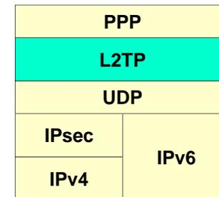
O L2TP cria os túneis usando o modelo cliente/servidor, o LNS (*L2TP Network Server*) é contactado no porto UDP 1701 pelo LAC (*L2TP Access Concentrator*) para se estabelecer o túnel. Cada túnel é ainda dividido em sessões, para cada protocolo acima do L2TP será usada uma sessão diferente.
