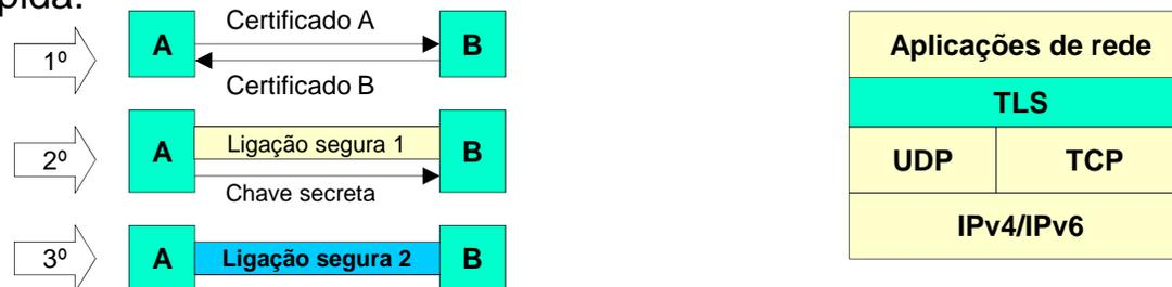
Tal como a sigla TLS indica, situa-se na camada de transporte (o IPsec encontra-se na camada de rede), assim sendo pode usar ligações TCP ou pacotes UDP. Os protocolos de aplicação podem tornar-se seguros sem grandes modificações se passarem a usar a camada TLS, atualmente quase todos os protocolos de aplicação dispõem de uma versão segura (“s”) que usa TLS: http/https; pop3/pop3s; smtp/smtps; etc. Não sendo uma implementação de VPN a camada TLS pode ser usada para esse efeito.
