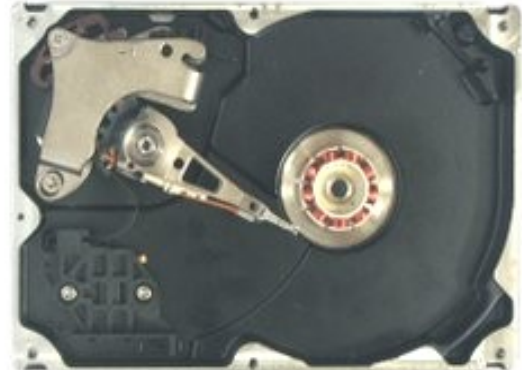
Foto 2- Vista interna de um disco duro
