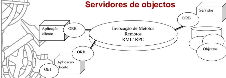
Um sistema deste tipo é implementado através de um conjunto de objectos que podem comunicar entre si. Objectos cliente comunicam com objectos servidores através do *Object Request Broker* (ORB).
